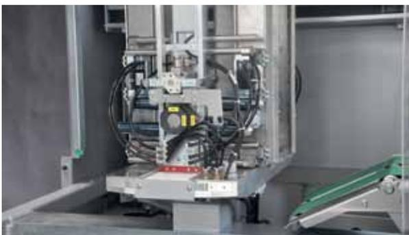
Klappbares Ausgabeband und optionale elektrische Drehkorbverstellung
